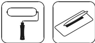
Для достижения наилучших результатов используйте валик **"Stream"** и шпатель **"Venicelook-Opus"**. Валиком с длинным ворсом создают объемную структуру материала, а шпателем, со слегка скошенной и сточенной кромкой, добиваются окончательного рисунка, характеризующегося участками различной толщины и блеска. Для обработки углов и труднодоступных мест в помещении применяйте кисть с длинной щетиной.
