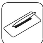
Наилучший результат достигается при использовании мастерка или шпателя из нержавеющей стали. Сразу же после работы промойте инструменты водой.
